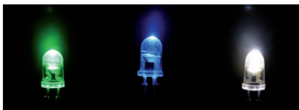
Abbildung 1. Grün und blau emittierende (\text{Ga}_{1-x}\text{In}_x)\text{N} -LEDs (links bzw. Mitte) sowie blaue LED, beschichtet mit dem gelben Leuchtstoff Ce-YAG ( \text{Y}_3\text{Al}_5\text{O}_{12}:\text{Ce}^{3+} , rechts).
